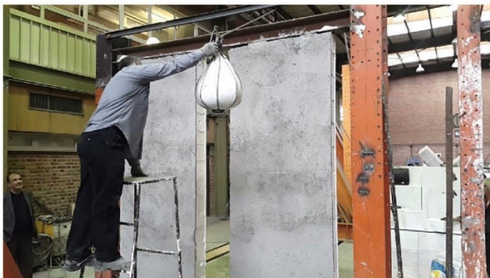
set up انجام تست ضربه جسم نرم سنگین
